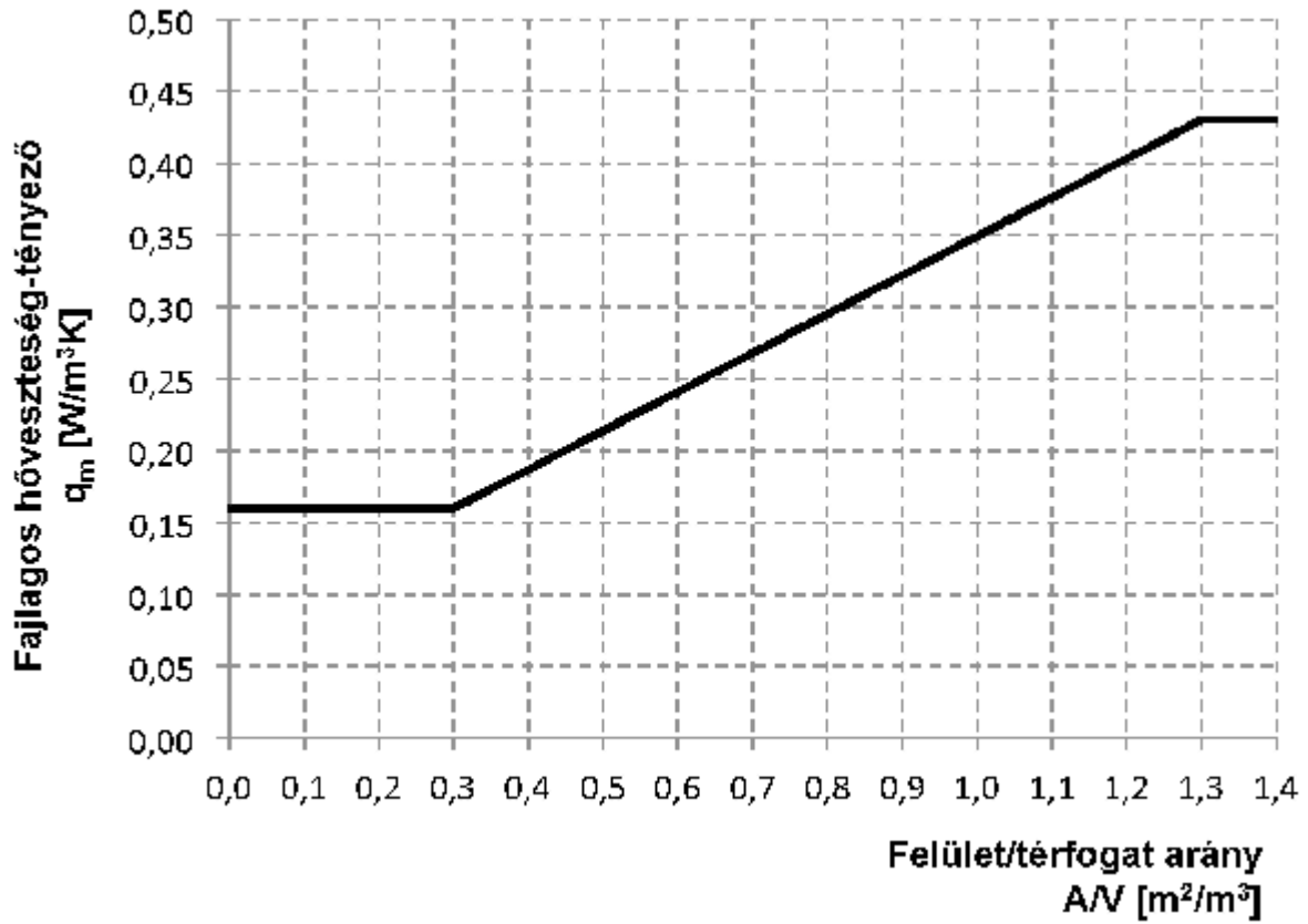
1. ábra. A fajlagos hővesztés-tényező követelményértéke
